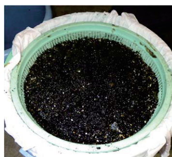
写真－5 洗浄後の沈砂等
