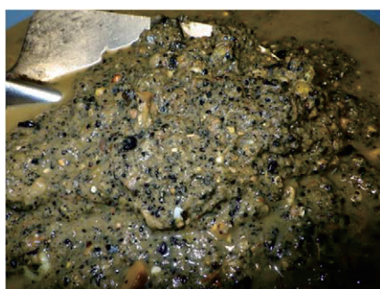
写真－4 し渣混じり沈砂
