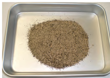
洗浄後（洗浄後の乾燥砂）
